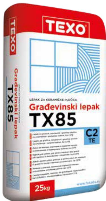
Namenjen za polaganje zidnih i podnih mermernih i granitnih ploča na čvrste cementne podloge, podloge od betona, a moguće je koristiti ga i za neravne površine. Koristi se za spoljašnje i unutrašnje radove. Otporan na vlagu, ekonomičan i jednostavan za upotrebu. Prema standardu EN 12004 klasifikuje se u grupu C2TE.
